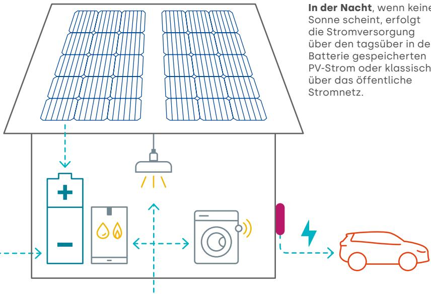
Ein leistungsfähiger **Batteriespeicher** dient als Zwischenspeicher, der tagsüber geladen wird und nachts oder bei hohem Energieverbrauch automatisch die Versorgung sichert.
